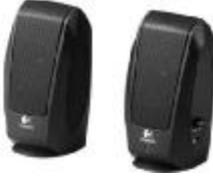
تستخدم في أنظمة تعدد الوسائط Multimedia لإخراج الصوت ، وتكون على شكل سماعات مستقلة توضع بجانب الحاسب أو على شكل سماعات تعلق على الرأس. ولا بد أن يكون الحاسب مزودا ببطاقة صوت Sound card ليعمل الصوت
